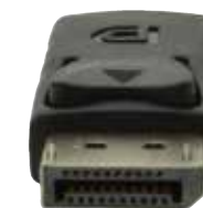
Détail connecteur DisplayPort
