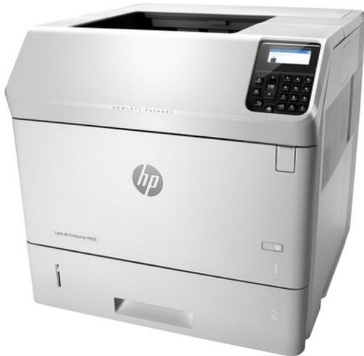
HP LaserJet Enterprise M605dn - Imprimante - Noir et blanc - Recto-verso - laser - A4/Legal - 1200 x 1200 ppp - jusqu'à 55 ppm - capacité : 600 feuilles - USB 2.0, Gigabit LAN, hôte USB 2.0test
