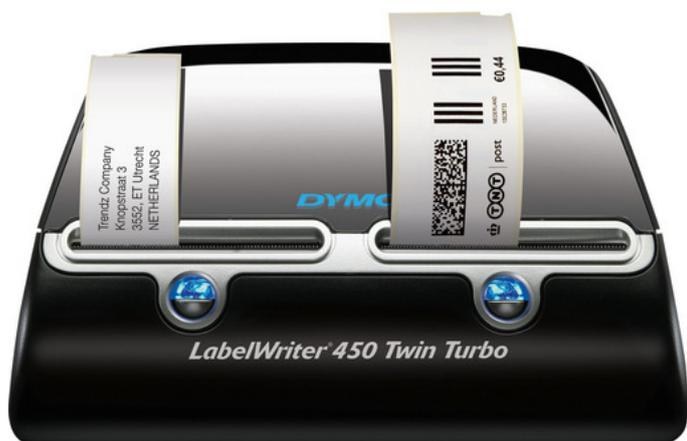
DYMO LabelWriter 450 Twin Turbo - Imprimante d'étiquettes - thermique direct - rouleau (6,2 cm) - 600 x 300 ppp - jusqu'à 71 étiquettes/minute - capacité : 2 rouleaux - USBtest
